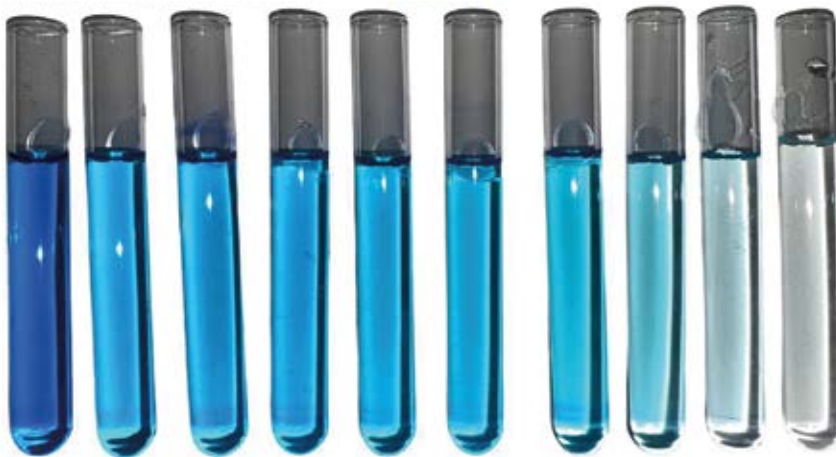
Figura 2 Muestras tomadas para la medición de concentración de colorante, cada muestra corresponde a un punto del gráfico (extremo izquierdo minuto -60 y extremo derecho minuto 60).
